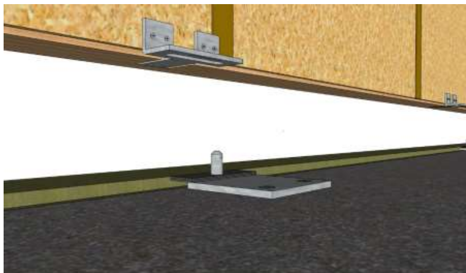
Figure 27 – Approche du panneau de l'étage supérieur pré-équipé de poignées (cas des façades indépendantes par niveau)
